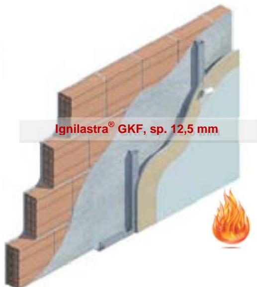
**CONTROPARETE KNAUF W623** ad orditura metallica con collegamento a parete, ingombro minimo 46,5 mm, costituita da:
