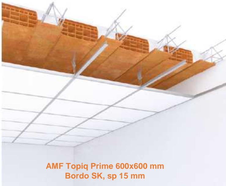
**Pannello:** AMF Topiq Prime, sistema SK, di dimensioni 600x600x15 mm
